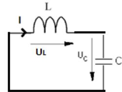
Tension aux bornes de la bobine :  $U_L = L \frac{dI}{dt}$
