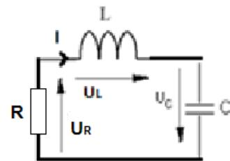
Tension aux bornes de la bobine :  $U_L = L \frac{dI}{dt}$
