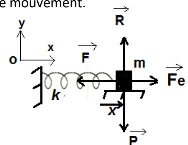
L'équation différentielle s'écrit alors :  $\ddot{x} + \frac{k}{m}x = \frac{F_0}{m} \cos \omega_e t$ ;  $\omega_0 = \sqrt{\frac{k}{m}}$  et  $a = \frac{F_0}{m}$
