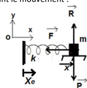
L'équation différentielle s'écrit alors :  $\ddot{x} + \frac{k}{m}x = \frac{kX_0}{m} \cos \omega_e t$ ;  $\omega_0 = \sqrt{\frac{k}{m}}$  et  $a = \frac{kX_0}{m}$
