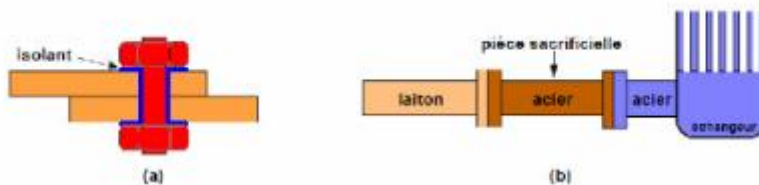
Protection contre la corrosion galvanique : (a) isolation électrique, (b) : pièce sacrificielle
