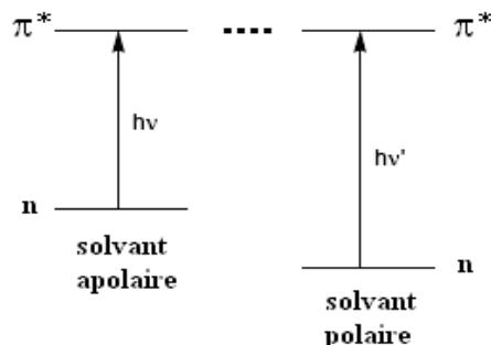
Avant l'absorption, la liaison  $\delta^+ C=O \delta^-$  est stabilisée par un solvant polaire. Il faut plus d'énergie pour provoquer la transition  $\Rightarrow \lambda$  diminue par augmentation de la polarité du solvant.
