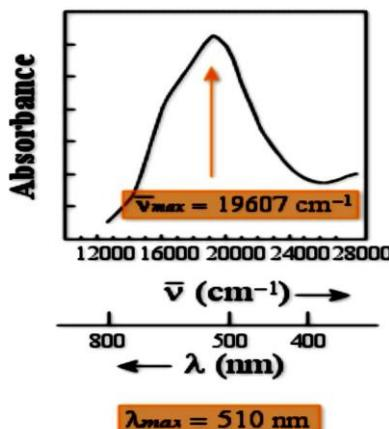
La position du maximum d'absorption correspond à la longueur d'onde de la radiation qui provoque la transition électronique. Quant à l'intensité, on peut montrer qu'elle est liée au moment dipolaire. Sa valeur permet de savoir si la transition est permise ou interdite.
