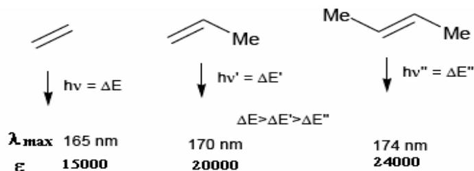
Pour les substituants à effet mésomère (auxochromes) portés par un chromophore C=C ou C=O, les paires d'électrons non-appariées peuvent participer à la résonance, augmentant la conjugaison d'une molécule : -OH, -OR, -X, -NH<sub>2</sub>, ... d'où des effets bathochrome et hyperchrome.
