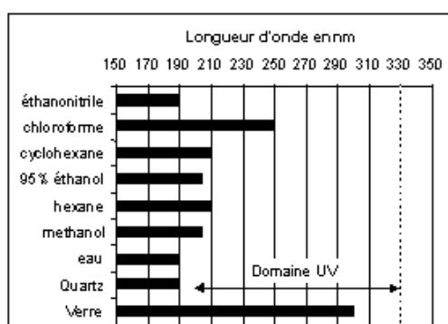
*Exemple : L'hexane peut être utilisé comme solvant pour des échantillons qui absorbent à des longueurs d'onde supérieures à 210 nm.*
