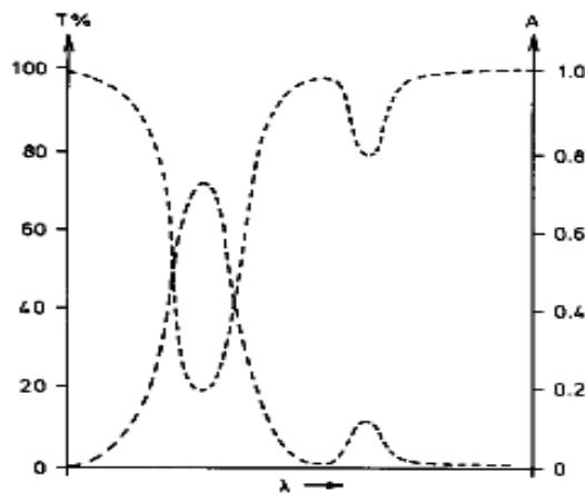
La bande d'absorption, observée dans le domaine de l'UV-visible, est caractérisée par sa position en longueur d'onde  $\lambda_{\max}$ , nm (ou en nombre d'onde,  $\text{cm}^{-1}$ ) et par son intensité reliée au coefficient d'extinction molaire  $\epsilon_{\max}$ .
