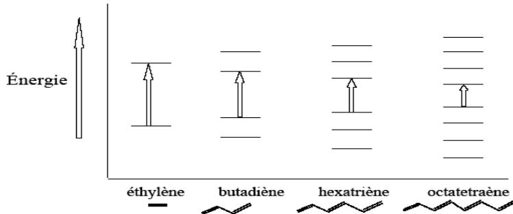
Il en découle un effet bathochrome et un effet hyperchrome sur la bande d'absorption correspondant à la transition  $\pi \rightarrow \pi^*$ .
