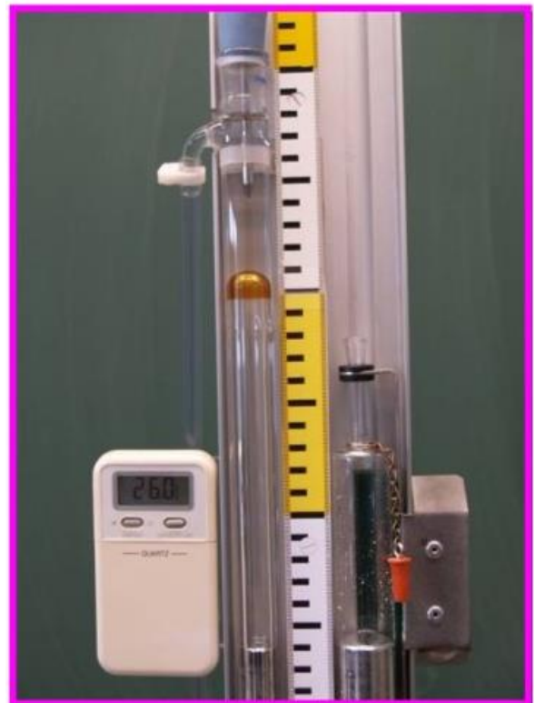
Figure2. Dispositif servant à l'étude des propriétés thermodynamiques des gaz parfaits.
