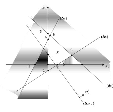
La fonction objective  $Z$  est représentée par l'équation  $2x_1 + x_2 = z_0(\Delta_{Z_0})$ . Pour  $z_0 = 2$  on aura  $2x_1 + x_2 = 2$ .
