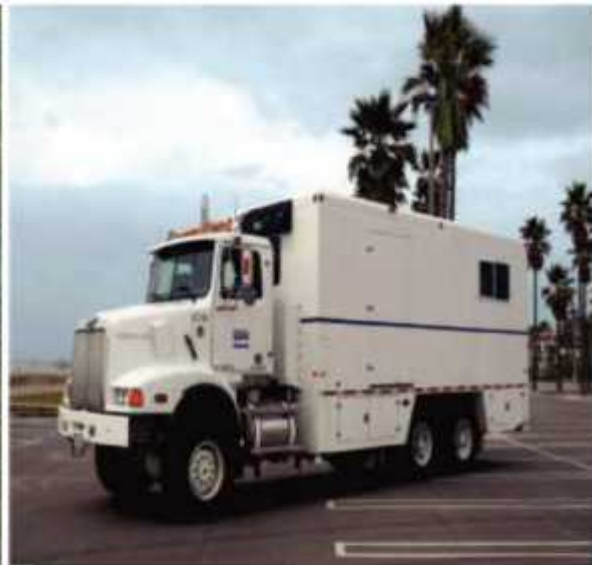
Figure I-2 : Unité CPT de 25 tonnes montée sur camion
