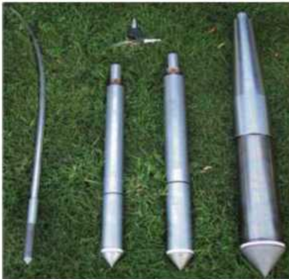
Figure I-1 : Gamme de sondes CPT (de gauche à droite : 2 cm 2 , 10 cm 2 , 15 cm 2 , 40 cm 2 )
