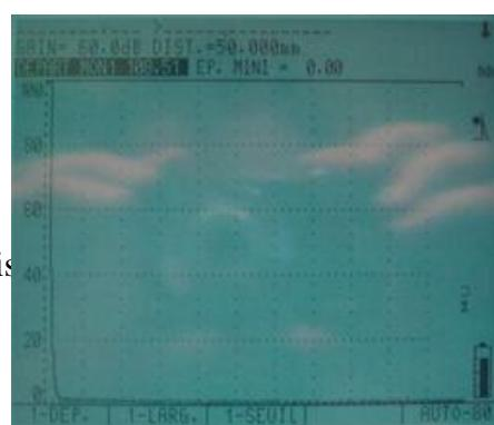
3) Mesurer la pièce en plastique suivante: Augmenter la valeur du gain à 60 dB en appuyant sur la touche
