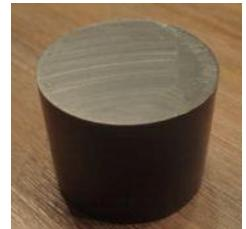
Calculer le temps mis par l'onde pour traverser la pièce et revenir au coupleur sachant que ce temps est égal à la distance mesurée divisée par la vitesse.
