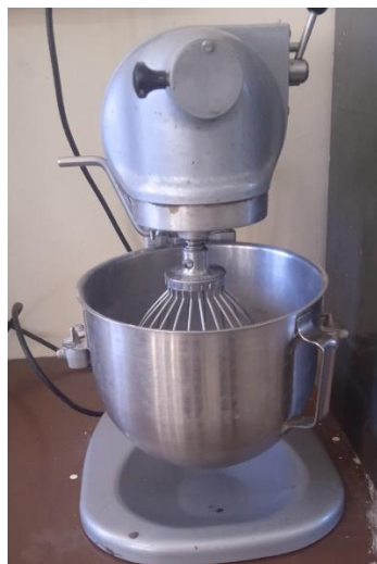
Figure II.10 : le malaxeur utilisée pour le mélange des échantillons
