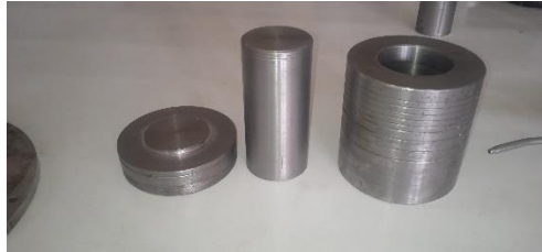
Figure II.11 : Le moule utilisée pour le pressage
