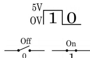
Le '0' et '1' logique peuvent être représentés par ON et OFF d'un interrupteur
