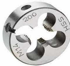
Le filetage de l'extrémité de la vis est obtenu à partir d'un arbre sur lequel ont été réalisées plusieurs rainures hélicoïdales. La partie pleine restante est appelée filet . Le filetage est obtenu à partir d'une filière (figures 21), sauf pour les filetages roulés où l'arbre est comprimé entre deux matrices qui, par écrasement de la matière, impriment la forme du filetage. Dans certains cas, les filetages sont également usinés sur des tours parallèles. [13]
