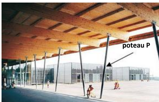
Figure '1' poteau en acier de 6m de longueur
