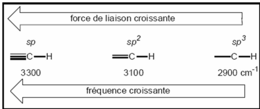
Effet de  $\mu$  : La fréquence de vibration est inversement proportionnelle à la masse réduite  $\mu$ .
