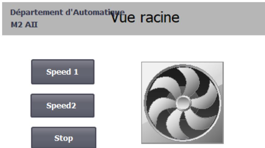
Les boutons « Speed 1 » et « Speed 2 » permettent de démarrer et de sélectionner la vitesse de fonctionnement du ventilateur. Le bouton stop permet d'arrêter le système.
