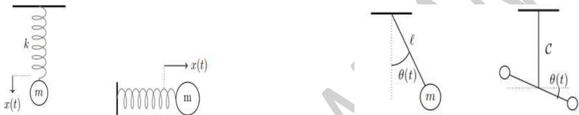
Fig.1 Les oscillations longitudinales ou transversales d'une masse accrochée ressort Fig.2 Les oscillations des pendules pesants ou des pendules de torsion.
