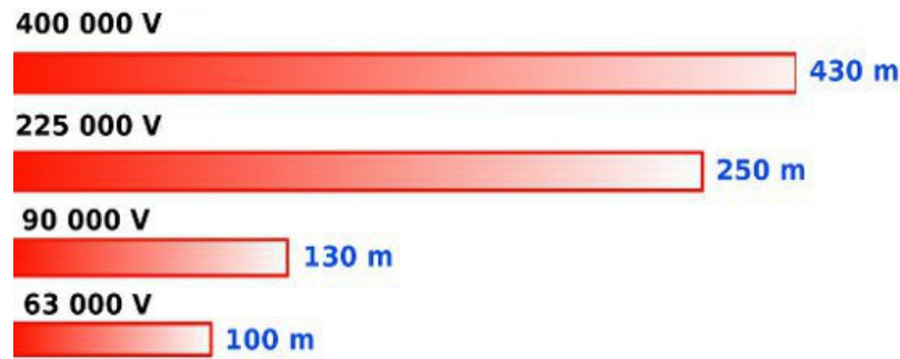
Fig.III.41 Distances estimatives conseillées pour une sécurité maximale en terrain dégagé
