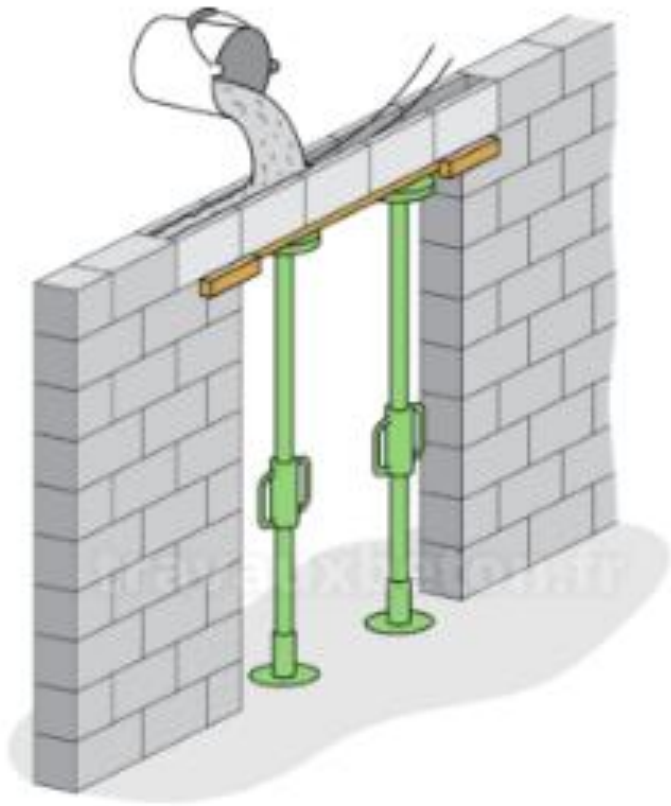
Linteau en béton armé coulé sur chantier
