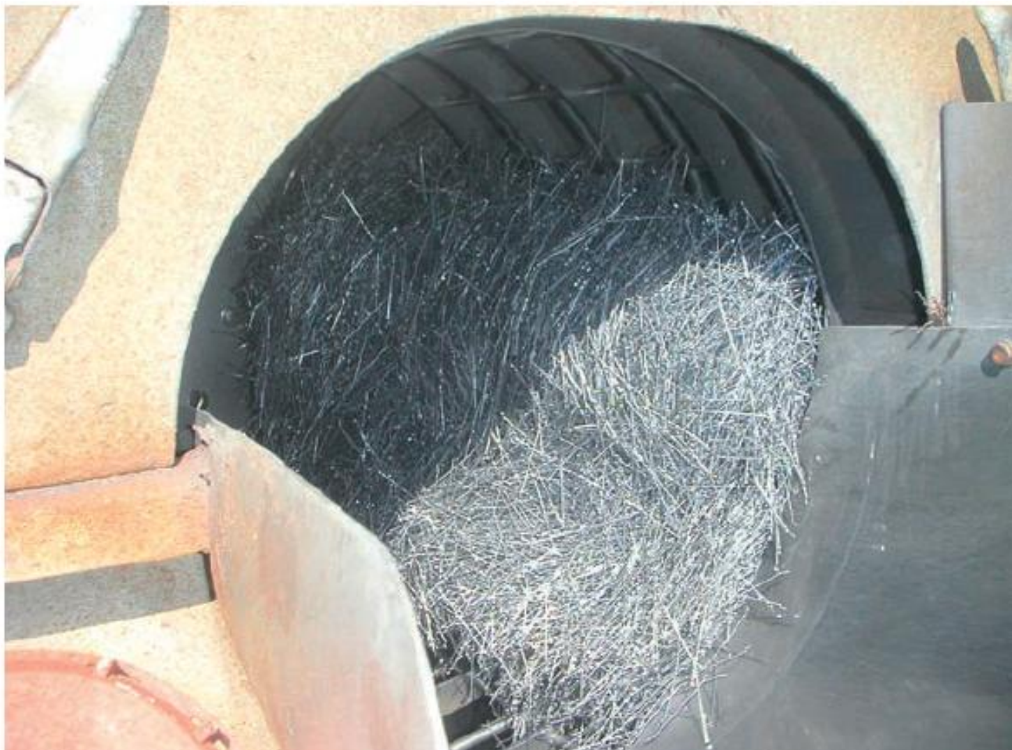
Introduction des fibres métalliques dans le malaxeur pour béton de dallage.
