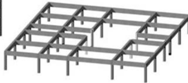
(b) vue du premier niveau de la partie supportant les actions verticales
