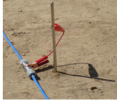
Centrale d'acquisition: Résistivimètre (Saris/Scintrex) et Electrode de mesure du courant électrique (F. Kessara, 2009)
