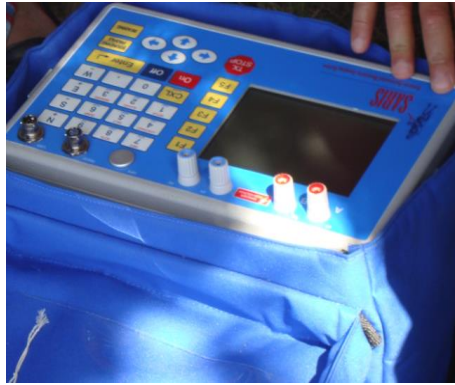
Centrale d'acquisition: Résistivimètre (Saris/Scintrex) et Electrode de mesure du courant électrique (F. Kessara, 2009)
