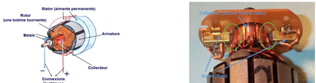
Figure 2.7. Dispositif Balais – collecteur.
