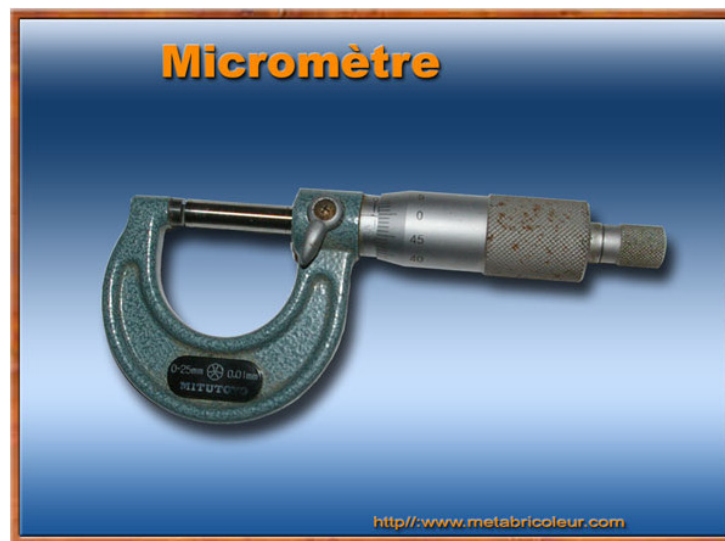
Figure 3 :Nouveau micromètre:1 tour de tambour = 0.5 mm (Tambour gradué de 0 à 49)
