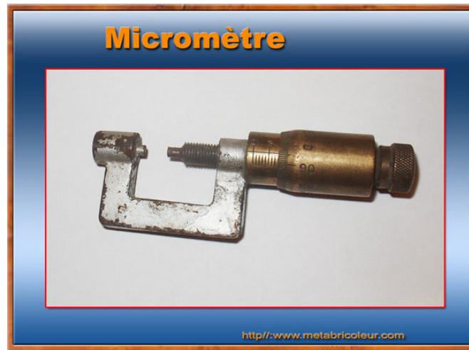
Figure 2 : Ancien micromètre: 1 tour de tambour = 1 mm (tambour gradué de 0 à 99)
