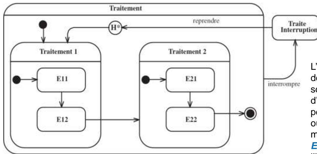
L'utilisation d'un historique profond permet de retrouver, après une interruption, le sous-état précédent. À la figure, l'utilisation d'un historique de surface H, au lieu de  $H^*$ , permettrait de retrouver l'état **Traitement1** ou **Traitement2** dans leur **sous-état initial**, mais pas les sous-états imbriqués **E11**, **E12**, **E21**, **E22**, qui étaient occupés avant l'interruption.
