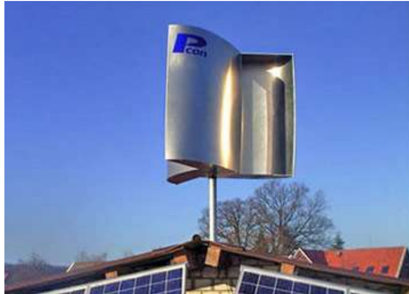
Eolienne à axe vertical de type Savonius intégrée sur une toiture en Allemagne
