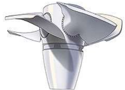
Turbine de type KAPLAN
