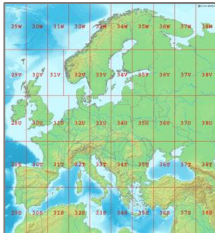
fig. n° [12] : La projection (UTM) couvre la surface terrestre par 60 fuseaux nord 60 fuseaux sud, chacun des fuseaux compte 6 degrés de longitude
