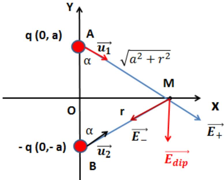
❖ **Potentiel de dipôle:** Principe de superposition:  $V_{dip} = V_+ + V_-$
