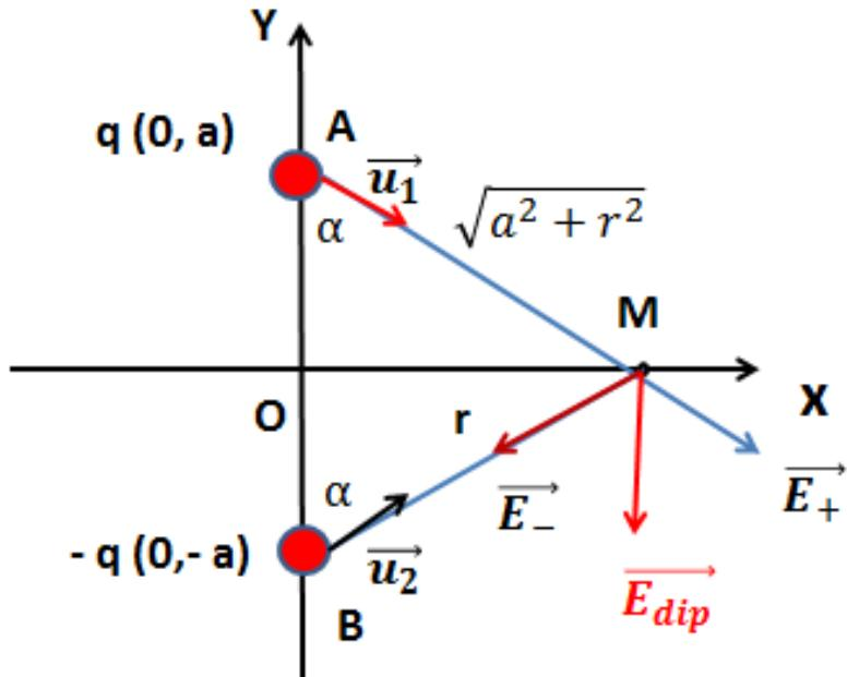
❖ Potentiel de dipôle: Principe de superposition:
