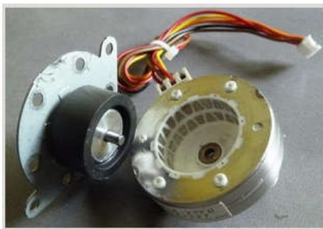
Figure 2.22. Structure d'un moteur pas à pas à aimant permanent.
