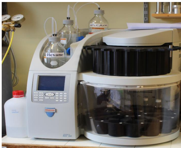
Figure 8 : Système de l'extraction par solvant accéléré
