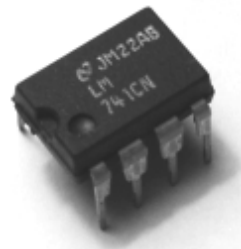
figure 2 : Circuit intégré d'un AO
