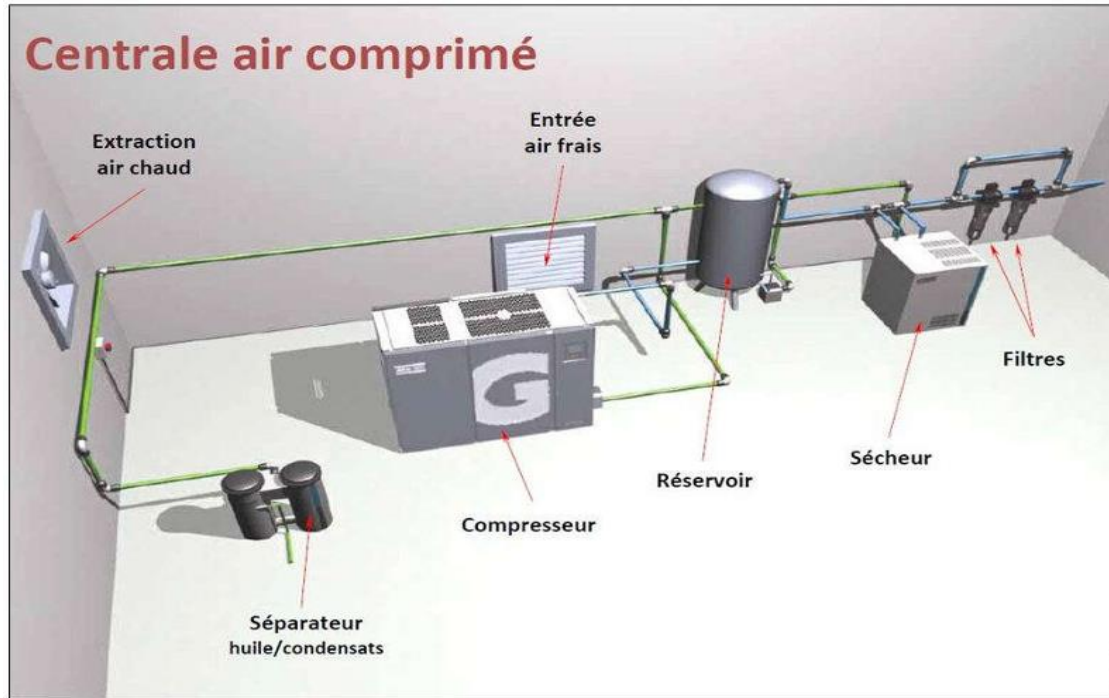
Fig. VI. 2 Unité de production d'air comprimé.
