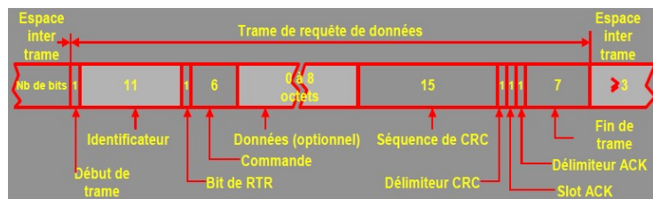
Figure 3.3 – La trame de requête
