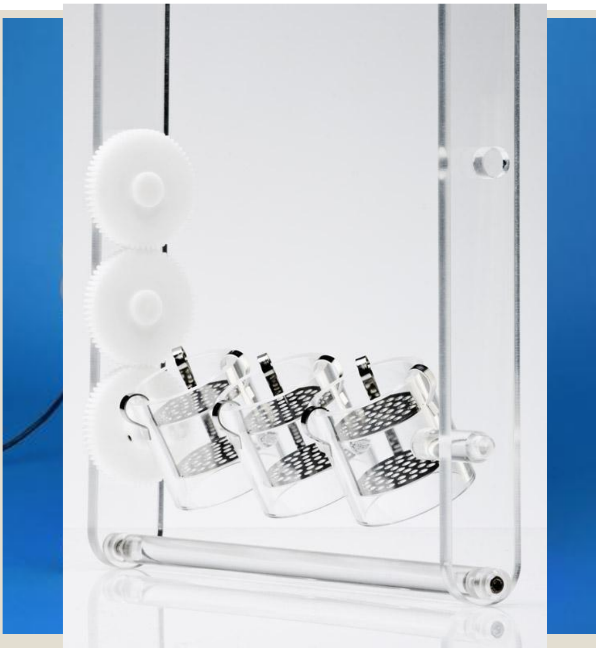
Appareil pour la désagrégation des suppositoires et des ovules
