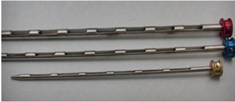
Figure 11. Sonde cylindrique à double tube (PASSEM, 2018).
