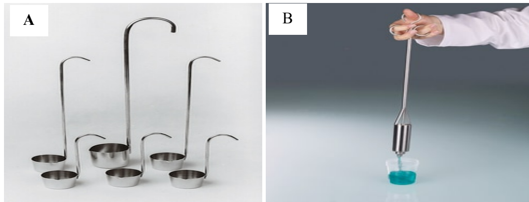
Figure 9. Échantillonneur de fond (A) ou à soupape (B) (ISO, 2015).
