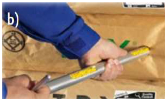
Figure 10. Instruments utilisés pour le prélèvement des produits solides : grandes pelle (a), et pelle à main (b) (ISO, 2017).
