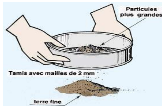
Figure 2 : Séparation de la terre fine et de la terre Grossière (Baize, 2018)
