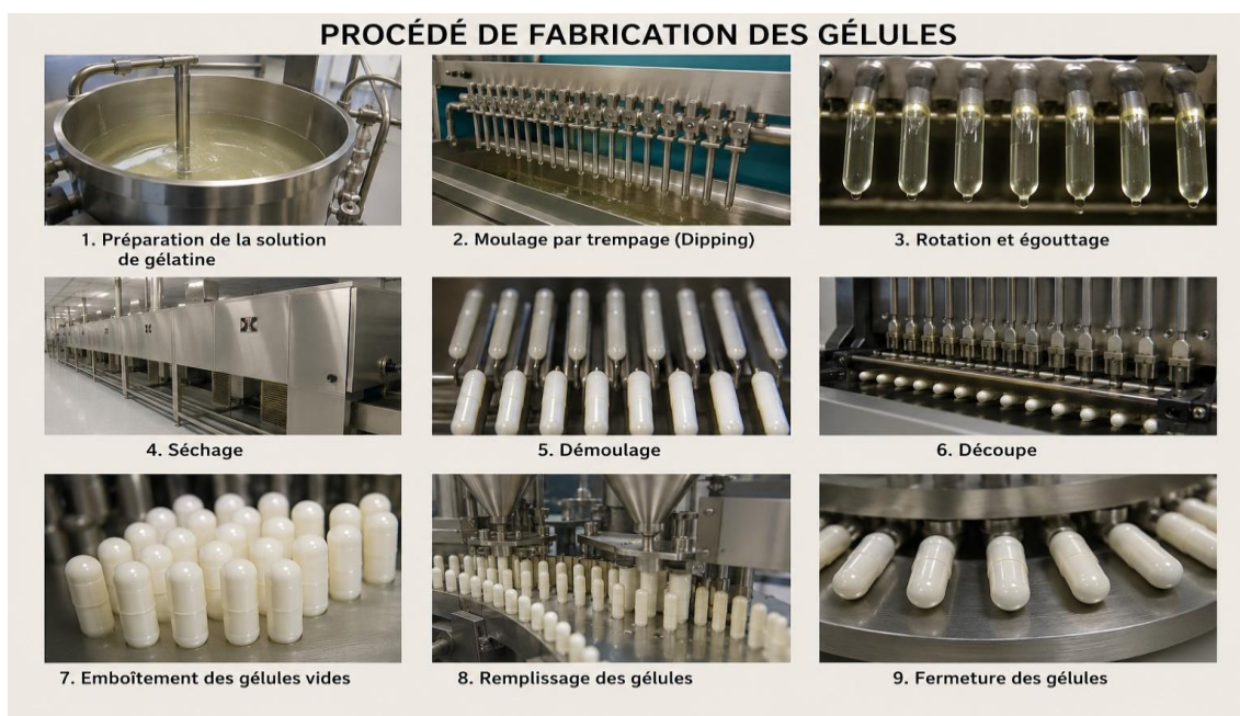
Figure 10. Procédé de fabrication industrielle des gélules dures Adapté de ( Aulton's Pharmaceuticals , 2022)
