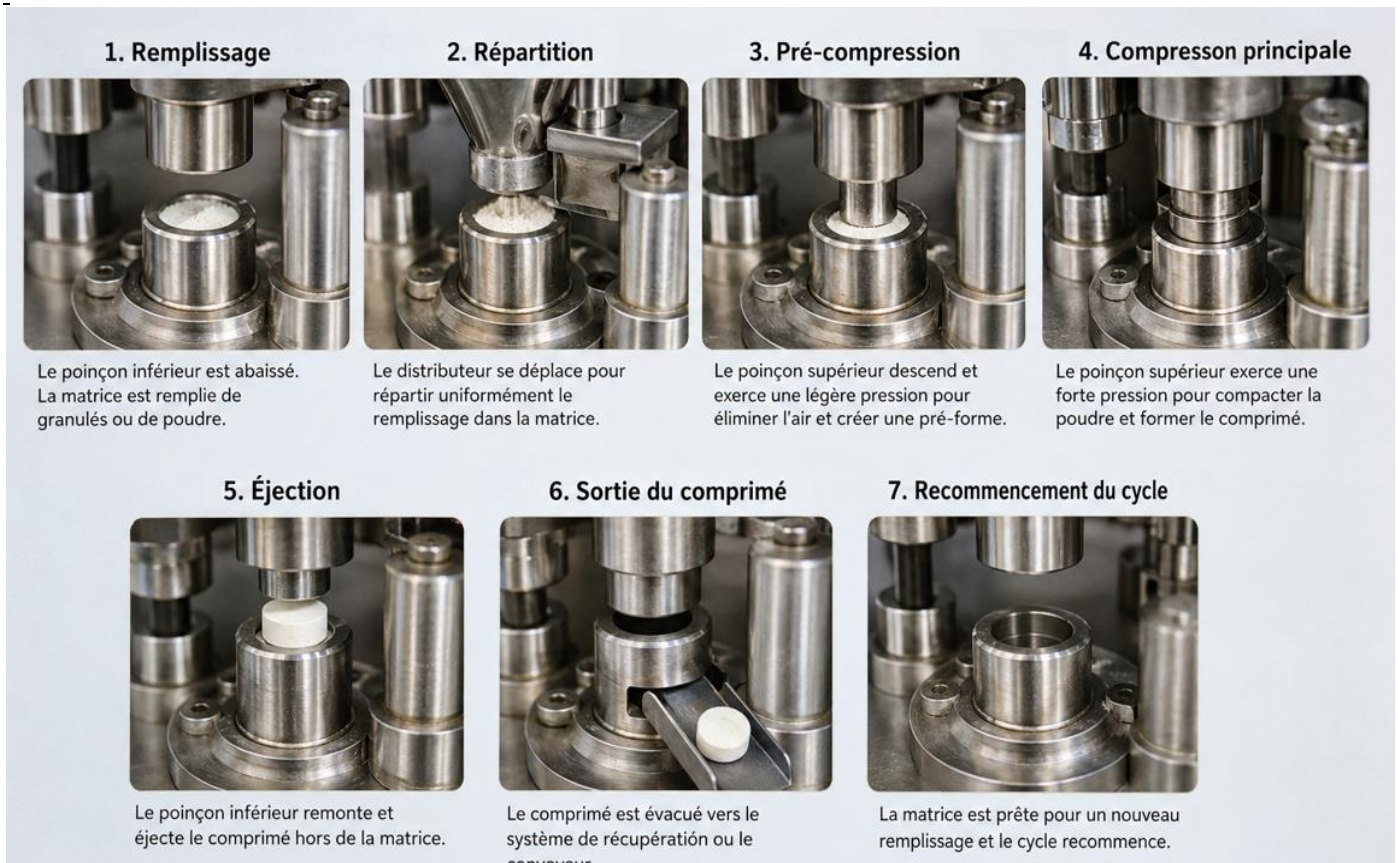
Figure 7. Représentation schématique des principales étapes de la compression des comprimés par une machine alternative (adaptée à partir de Aulton's Pharmaceuticals, 2022 ).
