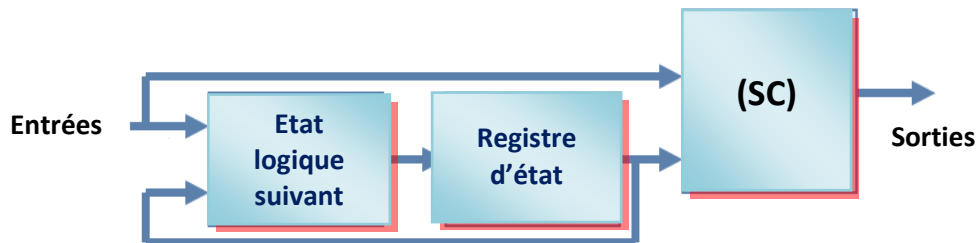
Figure 1.16 : Machine à états de Mealy.
