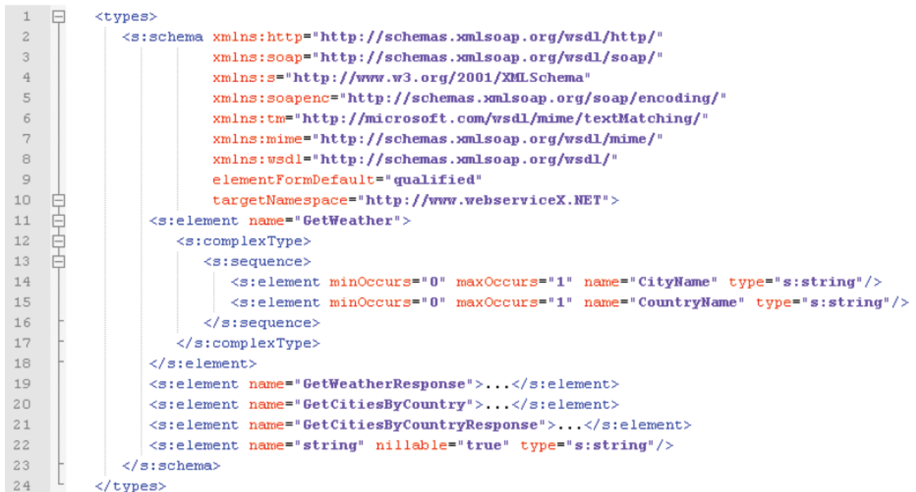
Figure 2.3: Utilisation de l'élément "types" dans la description du service web GlobalWeather
