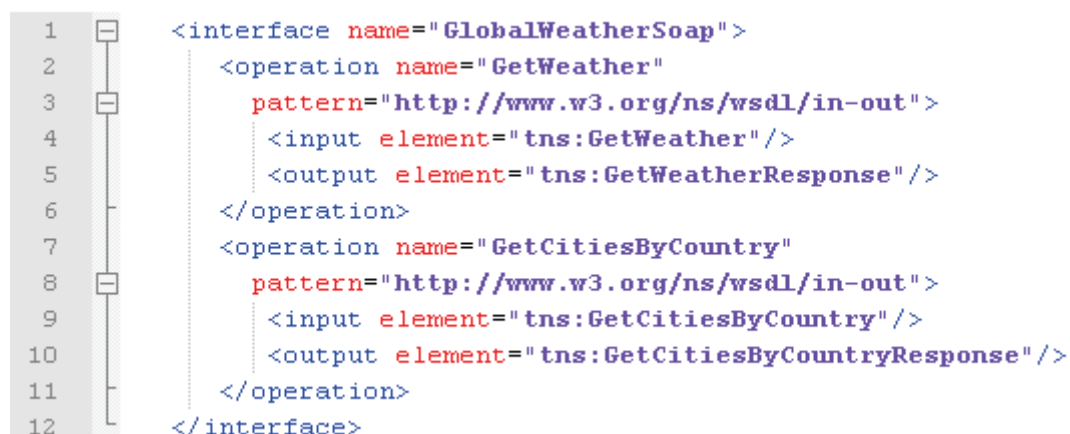
Figure 2.4: Utilisation de l'élément "interface" dans la description du service web GlobalWeather
