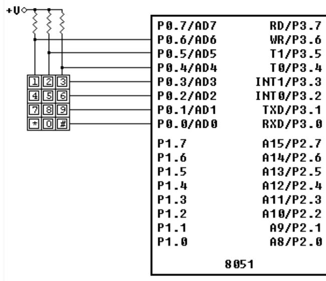
Pour effectuer la scrutation du clavier et lire la fermeture éventuelle d'une touche, on balaye le clavier en mettant chacune des 4 entrées P0.0 P0.1 P0.2 et P0.3 à l'état bas à tour de rôle et l'on vérifie si une sortie (P0.4 P0.5 P0.6) est à l'état bas (donc une touche est enfoncée). Dans ce cas, pour pouvoir identifier la touche enfoncée on ne peut fermer qu'une seule touche à la fois.
