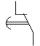
Contact inverseur (temporisé au travail)
