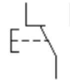
Bouton-poussoir (contact inverseur)
