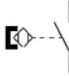
Contact Reed (contact normalement ouvert)
