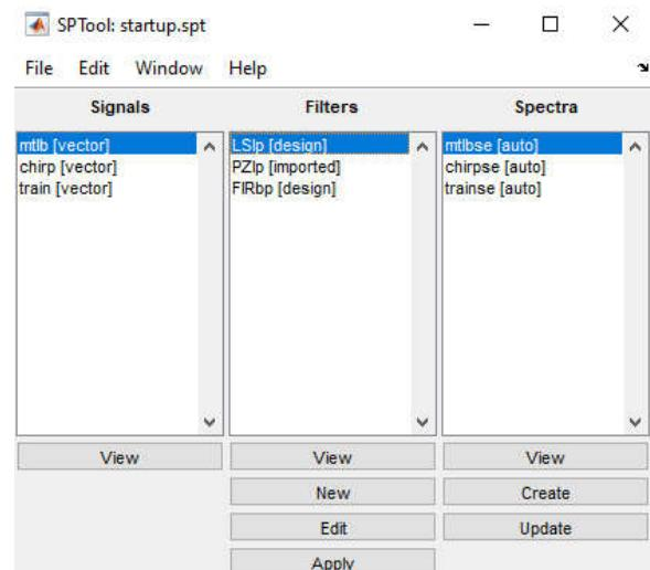
Dans la fenêtre de démarrage; deuxième colonne; sélectionnez nouveau (New). Une fenêtre de conception telle que celle illustrée dans la figure suivante est apparue. Dans cette fenêtre, sélectionnez le type de filtre (IIR elliptique), définissez la réponse sur passe-bas et spécifiez l'ordre du filtre à 10. Réglez la fréquence d'échantillonnage sur  $fs = 8$  kHz et la fréquence de coupure  $fc = 2400$  Hz.
