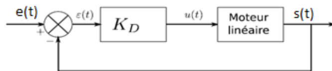
Figure 5.23 : Asservissement du moteur par l'action dérivée
