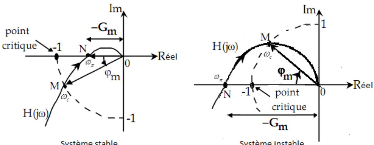
2- un système sera stable si, en parcourant le lieu de Black de la fonction de transfert en boucle ouverte dans le sens croissant des fréquences  $\omega$ , on laisse le point critique ( $-\pi$ ) à droite.
