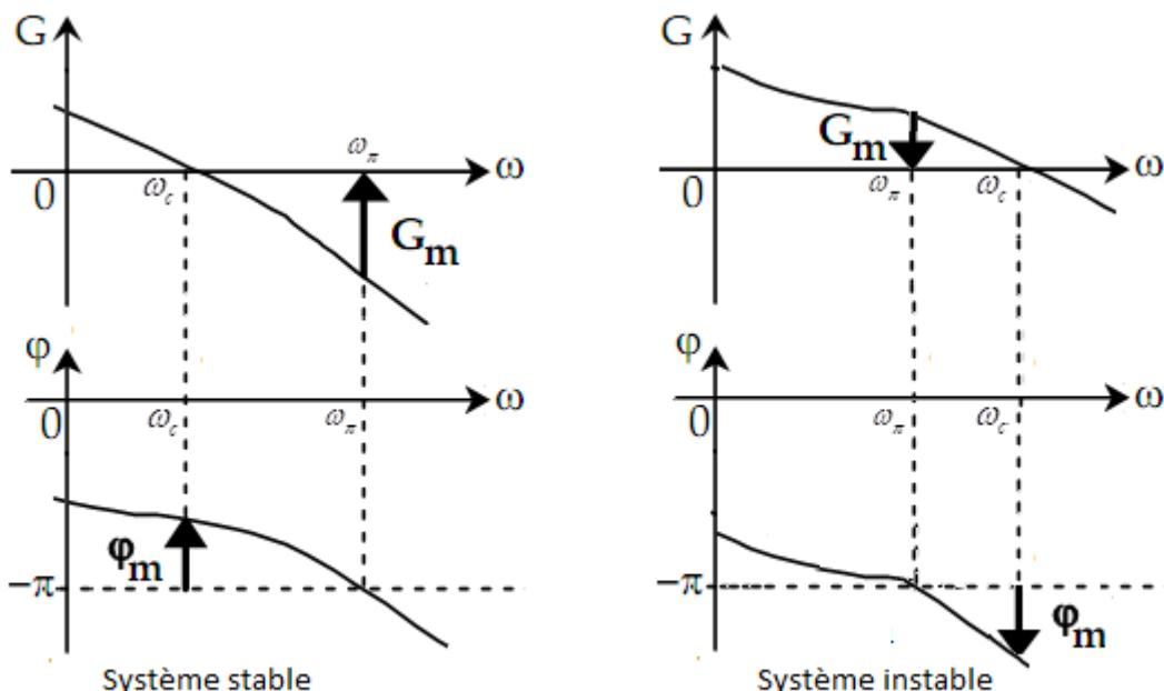
Diagramme de bode d'un système stable et instable
