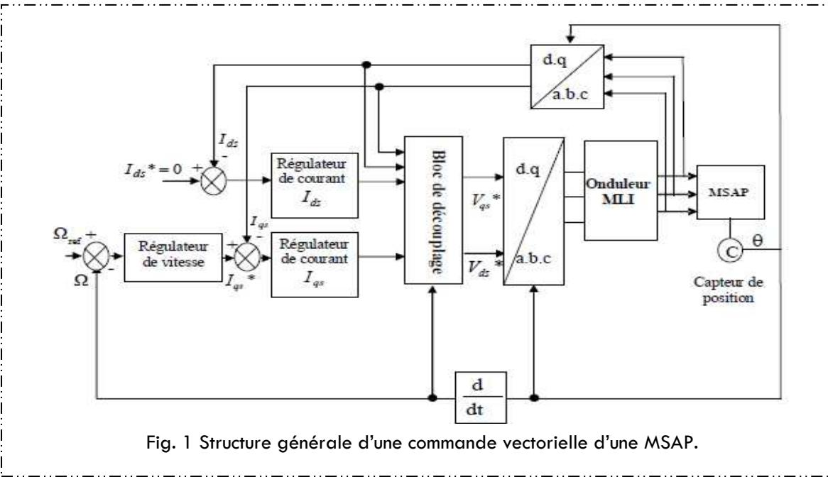
Fig. 1 Structure générale d'une commande vectorielle d'une MSAP.
