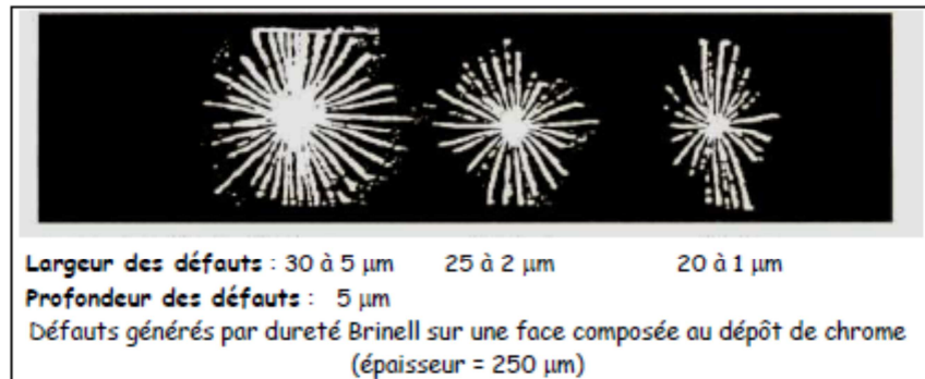
Aspect des indications obtenues par ressuage sur cales étalon.
