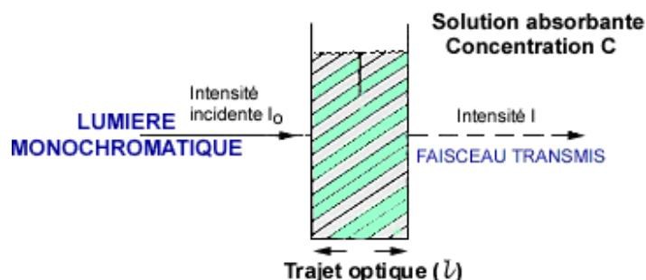
Une partie de ce rayonnement sera absorbée par l'échantillon et une partie sera transmise. Bouguer, Lambert et Beer ont étudié les relations qui existent entre  $I_0$  et I : *l'intensité d'une lumière monochromatique traversant un milieu où elle est absorbée décroît de façon exponentielle :*
