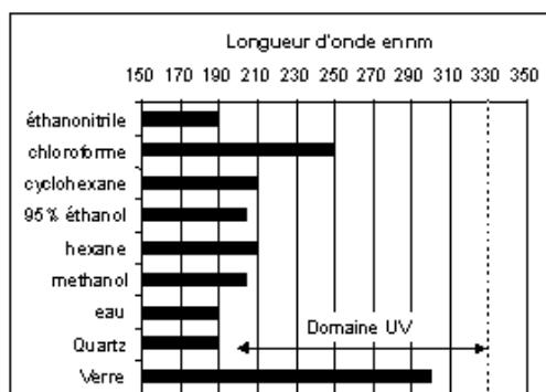
*Exemple : L'hexane peut être utilisé comme solvant pour des échantillons qui absorbent à des longueurs d'onde supérieures à 210 nm.*
