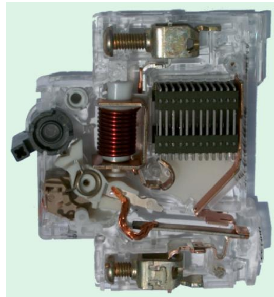
Figure 15 : Chambre de coupure & de fractionnement
