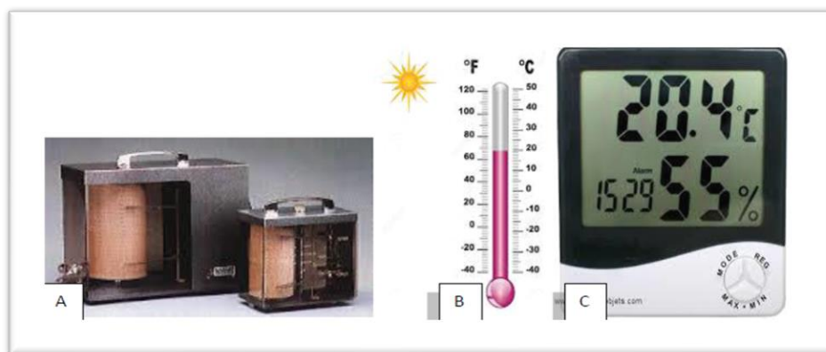
Figure 5. Différents appareils de mesures thermiques : (A) thermographe, (B) thermomètre à mercure, (C) thermomètre électronique
