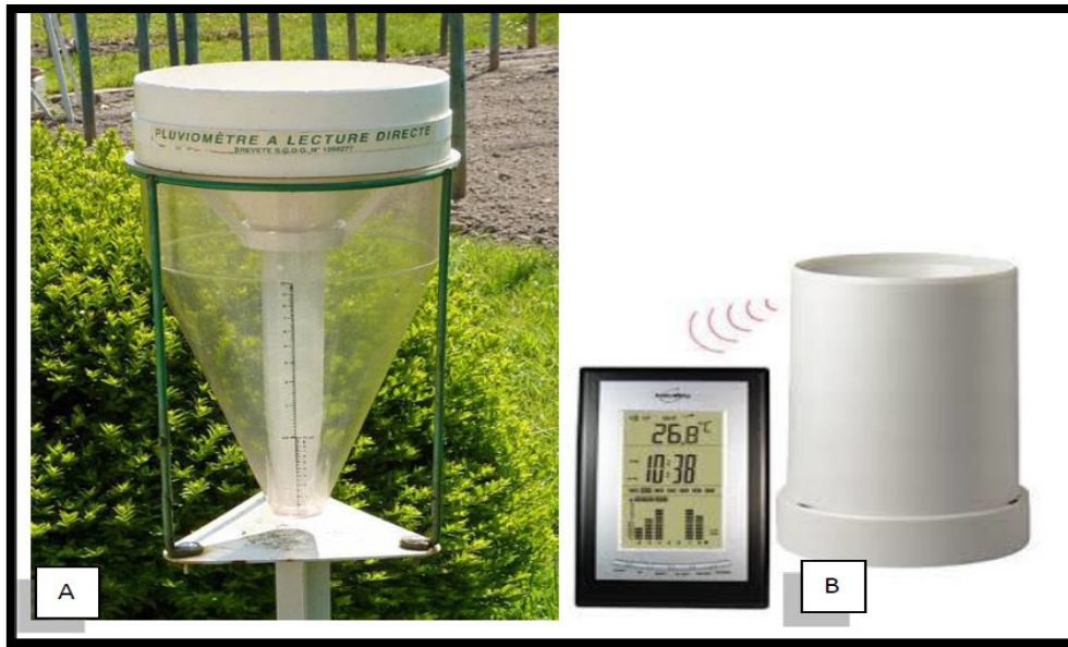
Figure1 : A-Pluviomètre à lecture directe B- pluviomètre électronique
