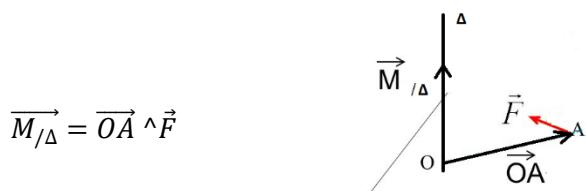
Le moment  $\overrightarrow{M}_{/\Delta}$  est perpendiculaire au plan formé par  $\overrightarrow{OA}$  et  $\vec{F}$ . Ce moment est nul si la direction de la force passe par l'axe de rotation ou si les vecteurs position et force sont colinéaires.
