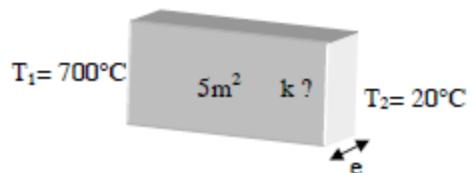
$$\frac{P}{S} = q = \frac{k}{e} (T_1 - T_2) \quad \text{et} \quad T(x) = \frac{(T_2 - T_1)}{e} x + T_1 \quad \text{équ. 3.14 et 3.15}$$
