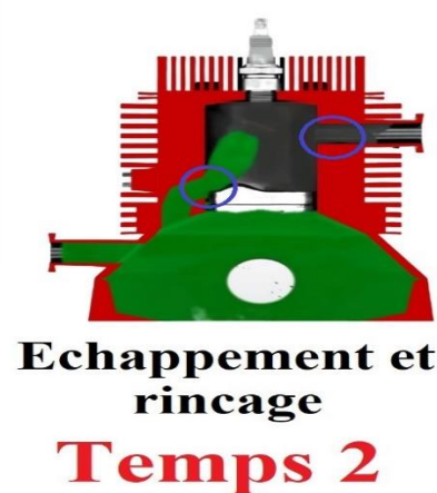
Figure I.6. Principe de fonctionnement d'un MCI à 2 temps.
